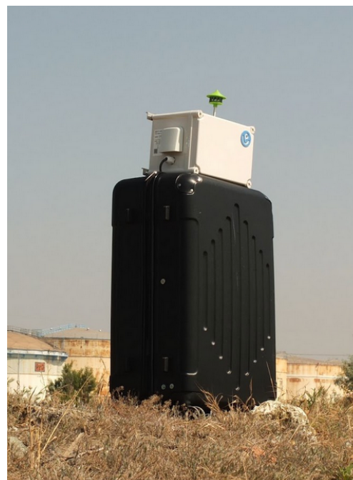
FIGURE 1 : Dispositif portable LOAC2/LivePollution pour la surveillance des concentrations en particules fines
